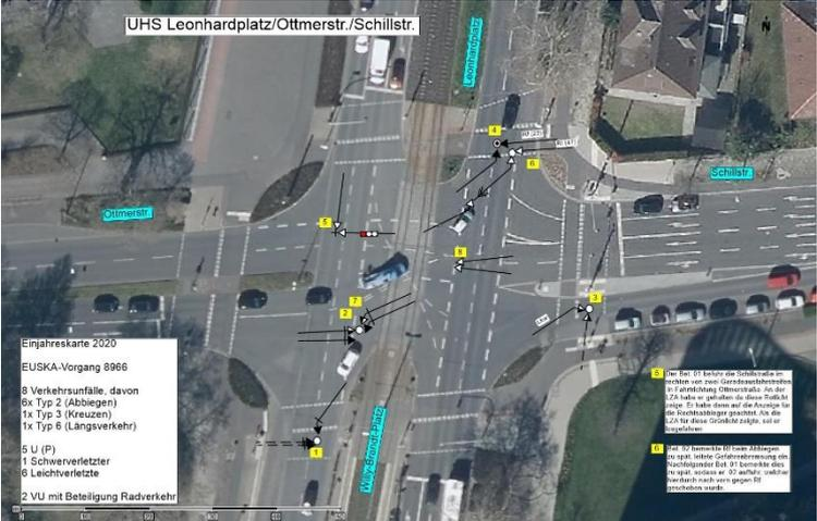
Die Umbauarbeiten im Bereiche dieser UHS wurden Ende 2018 beendet. Bis 2019 waren keine signifikanten Ursachen feststellbar. In 2020 entwickelte sich ein Konflikt mit Linksabbiegern. Die separate Signalisierung ist noch in Prüfung.
