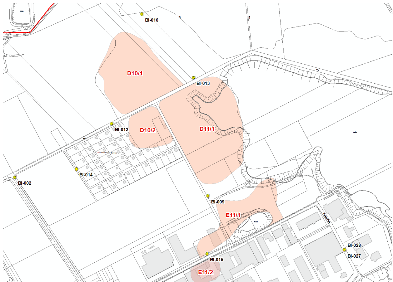
Abb. 7: Übersichtsplan der Altdeponien mit der Lage der Grundwasserpegel nördlich der Straße „Auf dem Anger“. Für die Überwachung der Altdeponie D 10/1 gab es früher einen Überwachungspegel im Grundwasserabstrom, der von einem Landwirt zerstört wurde. Das Grundstück mit der Altdeponie befindet sich im Privateigentum. Das Einverständnis für die Erstellung eines neuen Grundwasserpegels liegt vor (Erstellung möglich nach Ende der vorläufigen Haushaltsführung).
