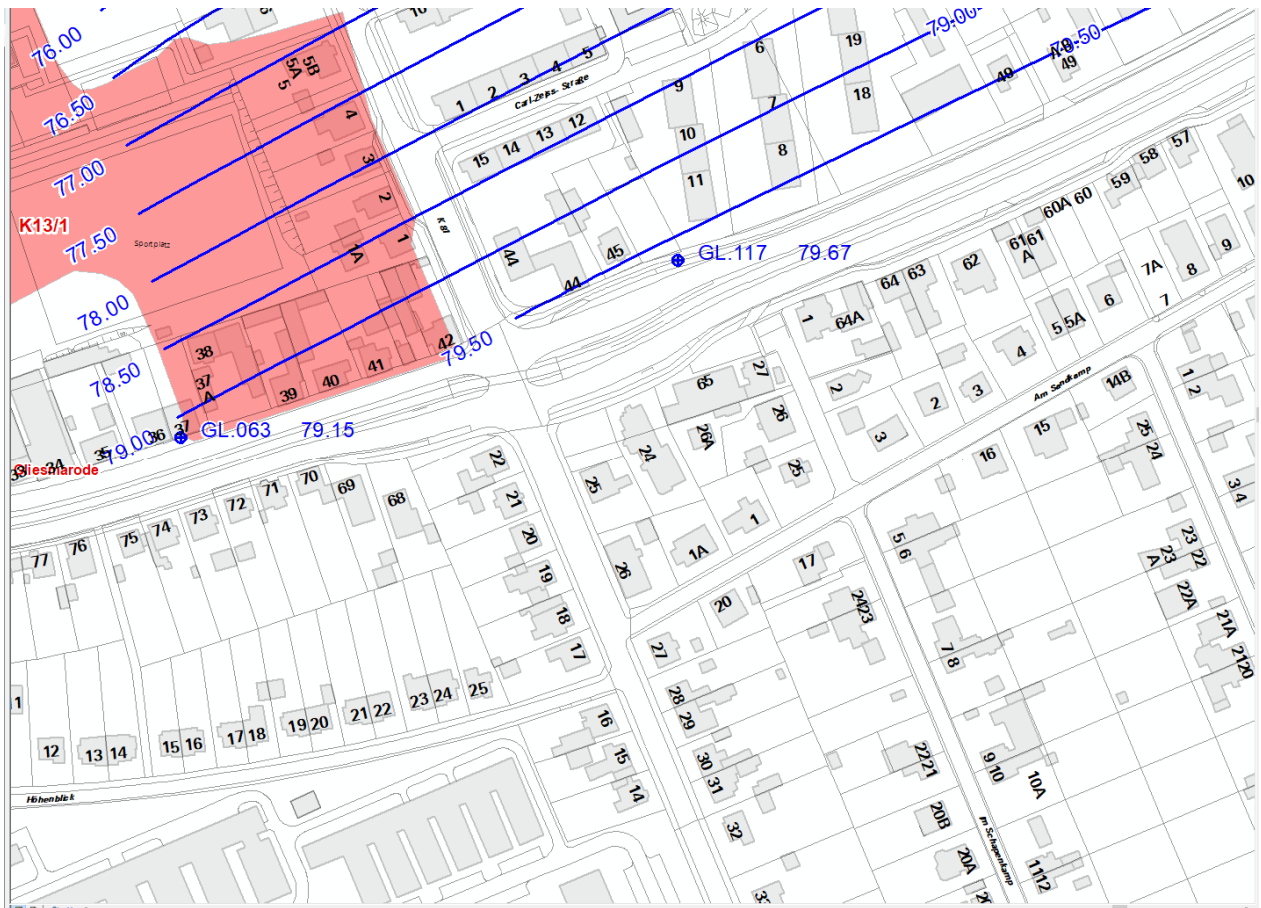
Abb. 52: Grundwassergleichenplan vom März 2021 zur Klärung der Herkunft von Nickel und Bor im Grundwasserzustrom zur Altablagerung K 13/1. Es wird ein Grundwasserpegel benötigt im Bürgersteig Ecke Am Sandkamp/ Im Schapenkamp, aus der Richtung strömt das mit Nickel und Bor verunreinigte Grundwasser an. Das Grundwasser im Pegel GL-117 ist mit diesen Stoffen belastet.
