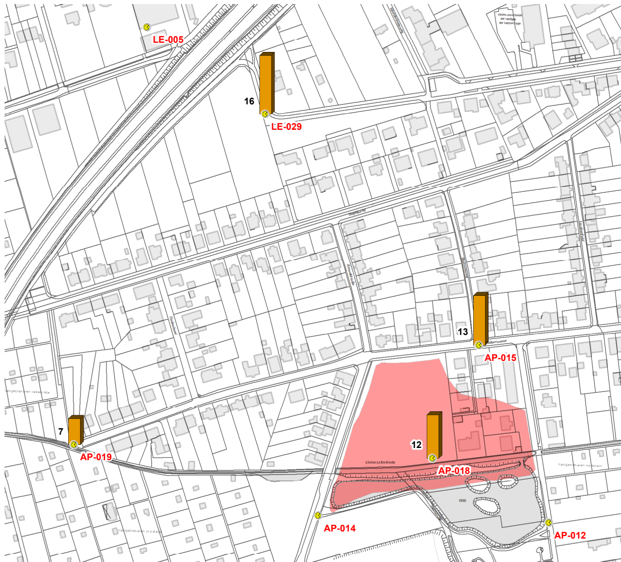
Abb. 61: Kupfer im Grundwasseranstrom und bei der Altablagerung, Zahlen in µg/l.
