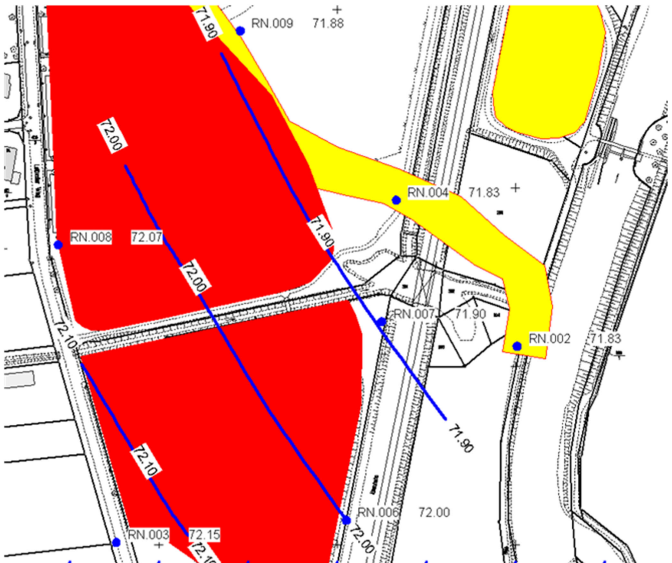
Abb. 147: Grundwassergleichenplan Mitte Oktober 2007. Das Grundwasser fließt von Südwesten nach Nordosten zur Oker.
