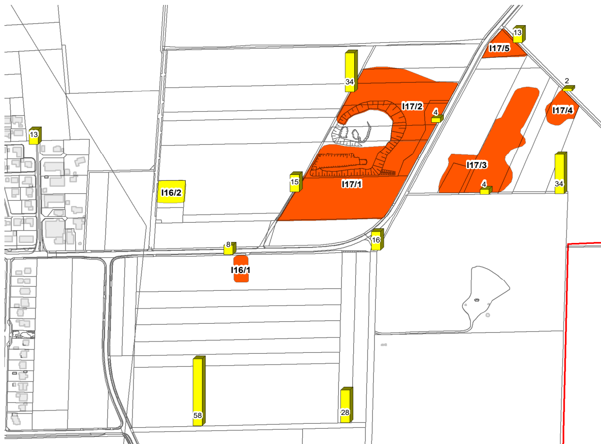
Abb. 47: Nickel im Grundwasserabstrom bei den Altablagerungen Schapen, Zahlen in µg/l.
