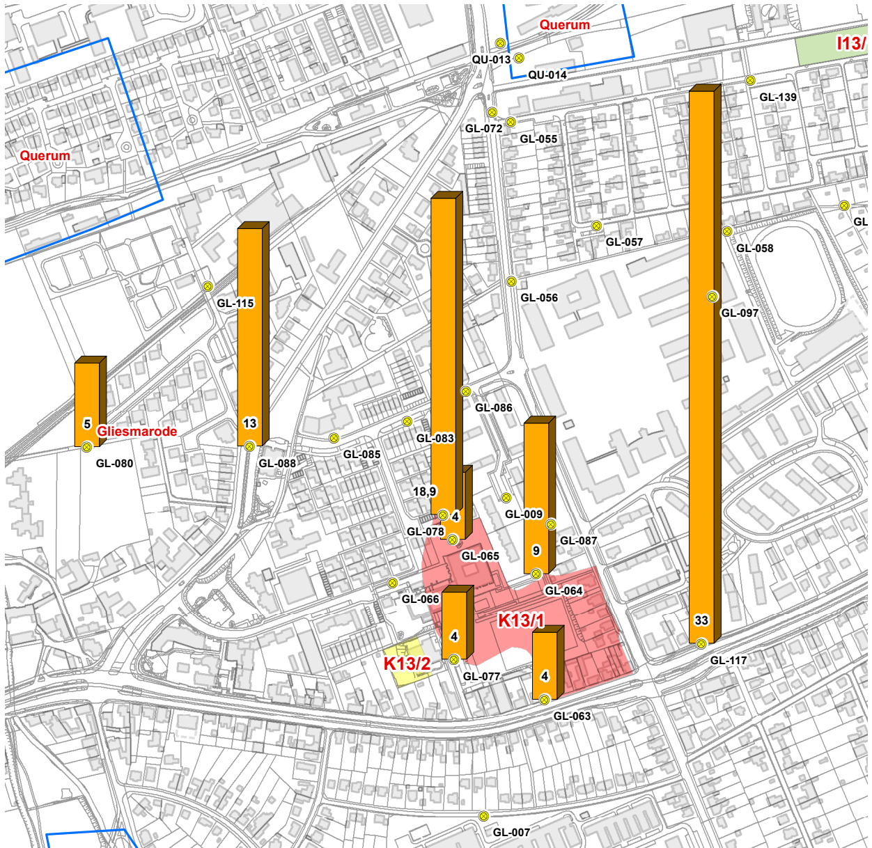
Abb. 53: Nickel im Grundwasser bei der Altablagerung K 13/1, Zahlen in µg/l, Analysen vom Dezember 2021 und Januar 2022. Die größte Nickelkonzentration ist im Grundwasserzustrom zur Altablagerung K 13/1 (Pegel GL-117).
