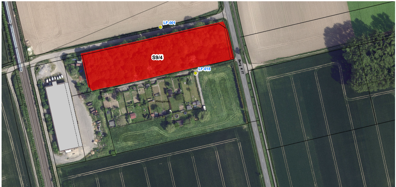
Abb. 153: Lageplan der Altdeponie S 9/4 mit den Grundwasserpegeln.
