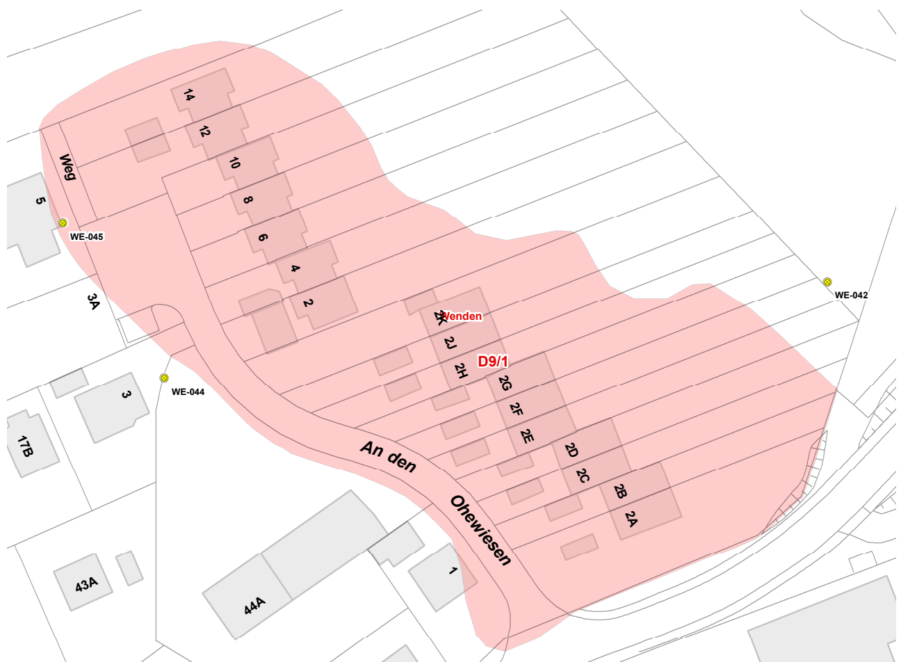
Abb. 98: Übersichtsplan der Altdeponie mit der Lage der Grundwasserpegel.
