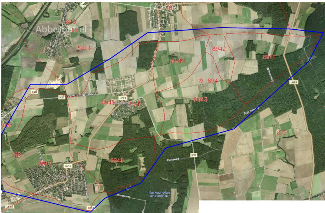
Abbildung 2: Auszug aus der hydrographischen Karte von Niedersachsen und Bremen (rot = Einzugsgebiete; blau = Planungseinzugsgebiet)
