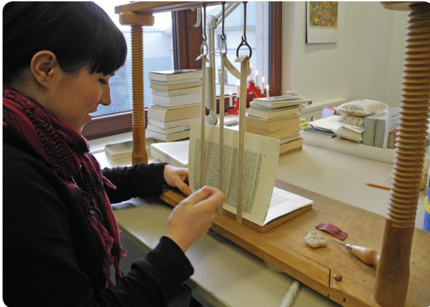
Nadel und Faden gehören noch immer zum Handwerkszeug einer Buchbinderin. Links demonstriert Inga-Malin Rosch anhand einer Heftvorrichtung wie die Buchseiten geheftet werden, rechts ein Blick in eine historische Buchbinderei (Quelle: „Was willst du werden? Bilder aus dem Handwerkerleben“, Berlin 1880).
