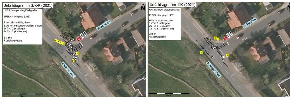
Die UKo empfiehlt als Sofortmaßnahme die Haltelinie zum VZ 206 im Siekgraben näher an die Markierung der Fußgängerfurt zu verlegen. Die Markierungen der Furt sollen erneuert, die Furt mit einem Piktogramm „Radverkehr“ und Pfeilen in beide Richtungen versehen werden.
