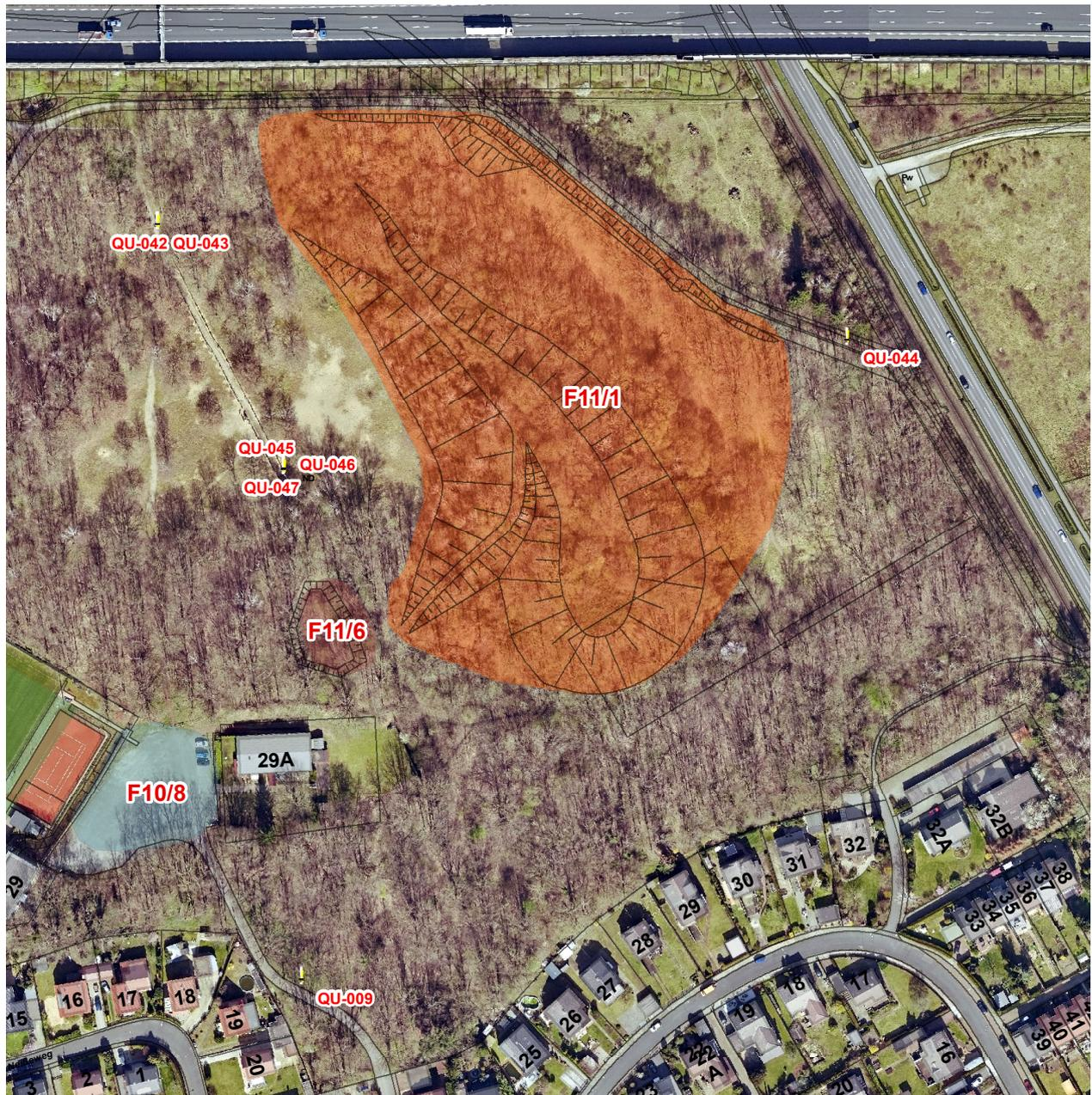
Abb. 16: Übersichtsplan der Altdeponie F 11/1 mit der Lage der Grundwasserpegel. Bei dem Pegel QU-045 befindet sich eine 3-fach Messstelle, QU-045, QU-046 und QU-047.
