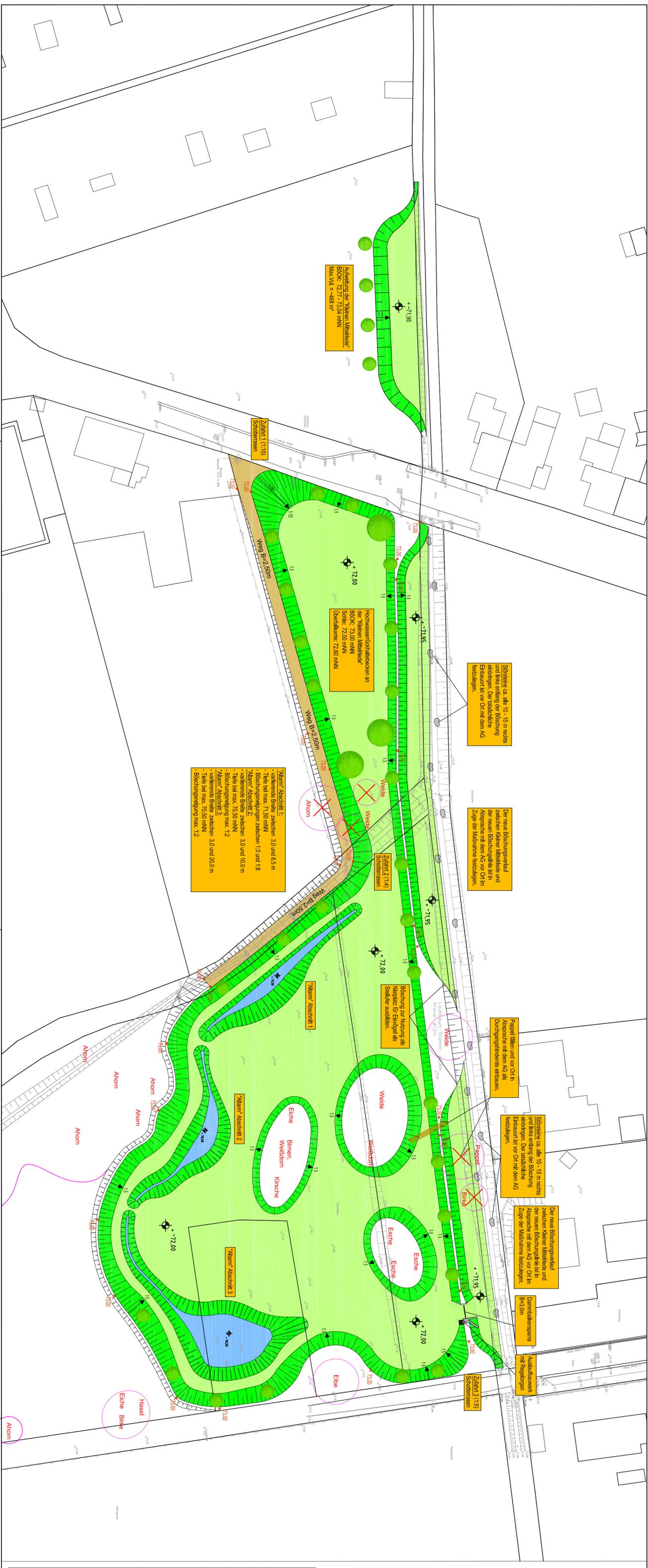
Störsäule ca. alle 10 - 15 m rechts und links entlang der Böschung einbringen. Der ästhetische Eindruck ist vor Ort mit dem AG festzulegen.
