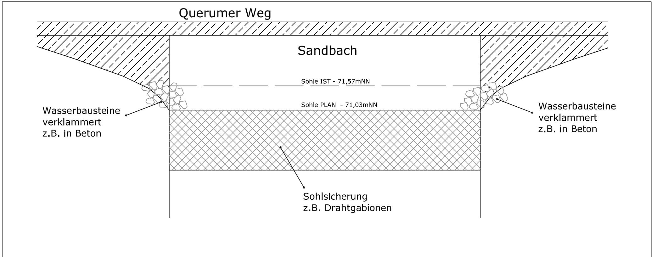
Die Sicherungsmaßnahmen werden an die Anforderungen hinsichtlich der Brückenstatik, der Brückengründung und der Erosionsstabilität angepasst. Dementsprechend sind vor Baubeginn genauere Untersuchungen der Brückengründung erforderlich.
