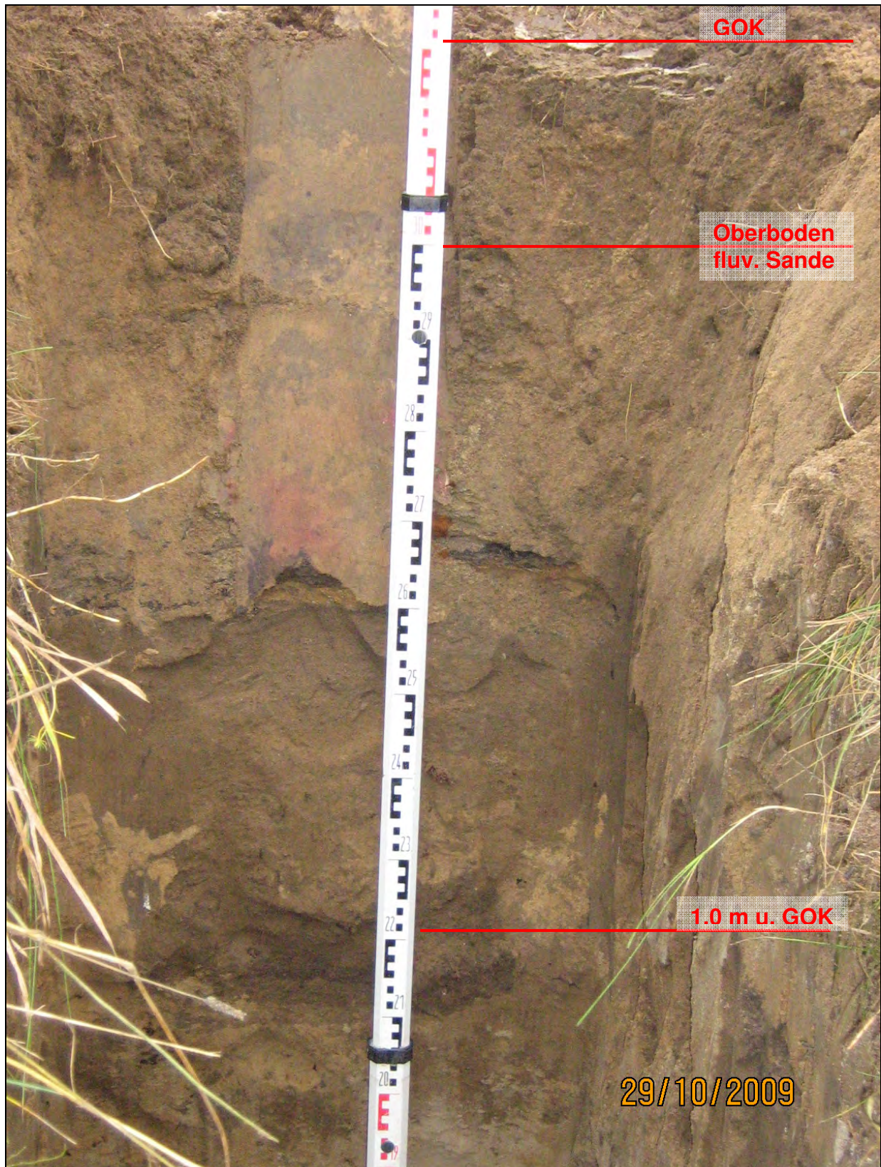
Abbildung 3: Baggerschurf 0,00 bis 1,30 m u. GOK
