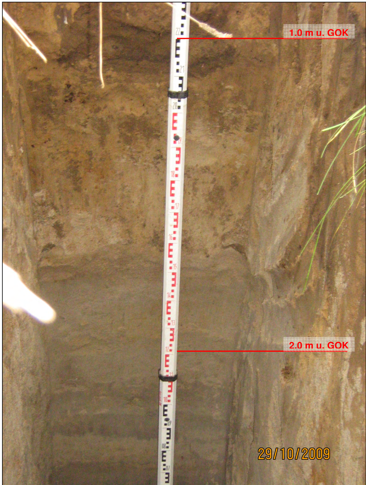
Abbildung 4: Baggerschurf 1,00 bis 2,50 m u. GOK
