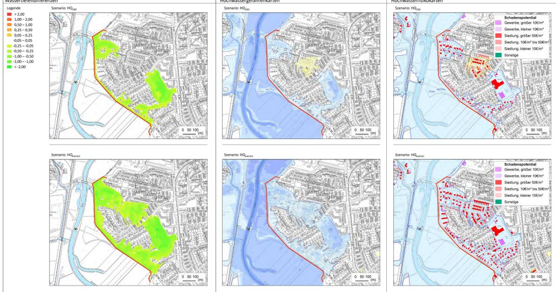
Kanaliserungsaspekte – betrefene Regenwasserkanalisation und entsprechende Schutzmaßnahmen
