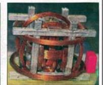
Solche Magnetometer haben Braunschweiger Spezialisten für jeden der fünf Satelliten entwickelt und gebaut.
